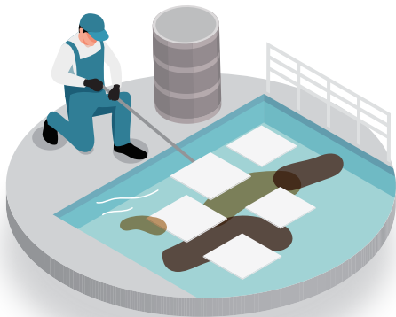
油水分離槽内の浮上油回収
